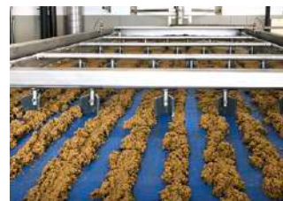
Eingedickter Schlamm auf Seihband
