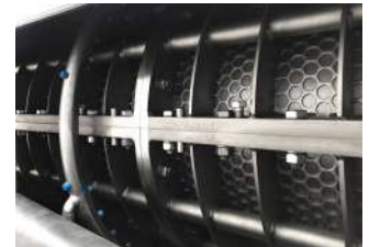
Robuster Edelstahl-Siebkorb, horizontal und vertikal segmentiert
