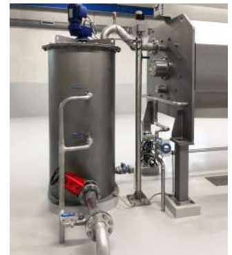
Reaktor – Betrieb der Anlage unter Druck, optimale Einmischung des Flockungsmittels
