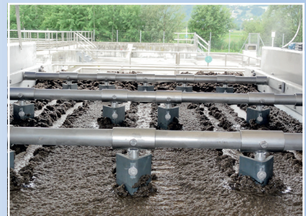
Eingedickter Schlamm auf Seihzone Durchsatz bis 30 m 3 /h
